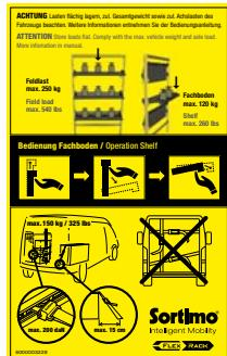
Esta etiqueta de seguridad se encuentra en el separador de su vehículo. En la etiqueta de seguridad se indica la carga máxima de un estante y el manejo del FlexRack.
